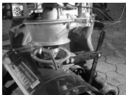
Spoj motorja s pogonom je zavarovan z ohišjem. Ta rešitev vam omogoča menjavanje zgornjega dela prekopalnika z drugim tipom. Sistem nožev je razporejen tako da zemljo enakomerno obdelava in je ne obrača. Širino obdelovanja lahko spremenimo po želji z odvzemanjem oz. dodajanjem
